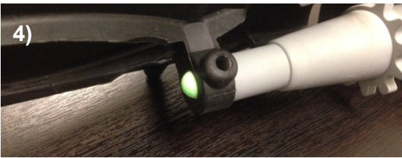
4) Note foam plug. Push out or remove plug.
